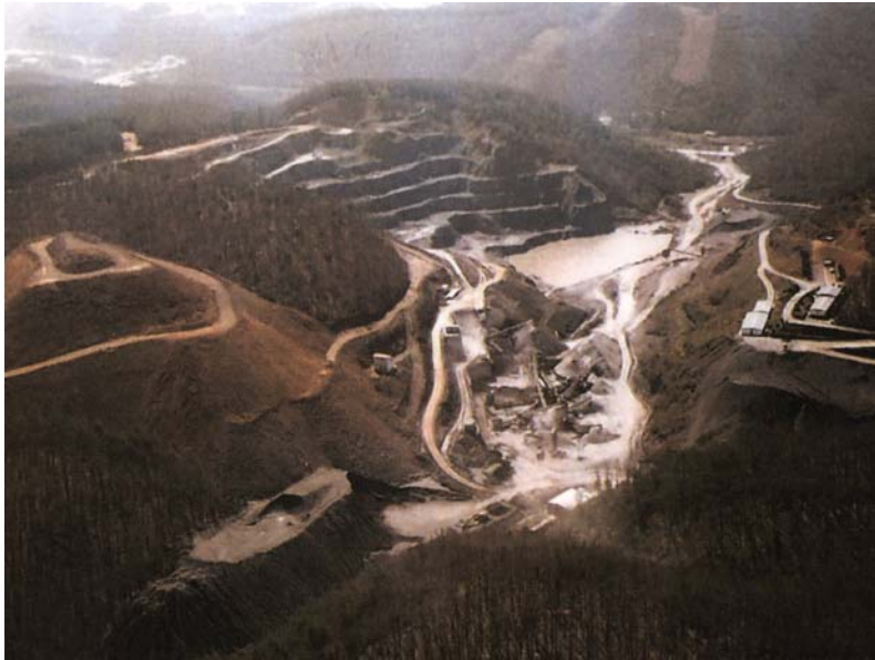
Ayna-basamak sisteminin uygulandığı örnek bir agrega işletmesi
