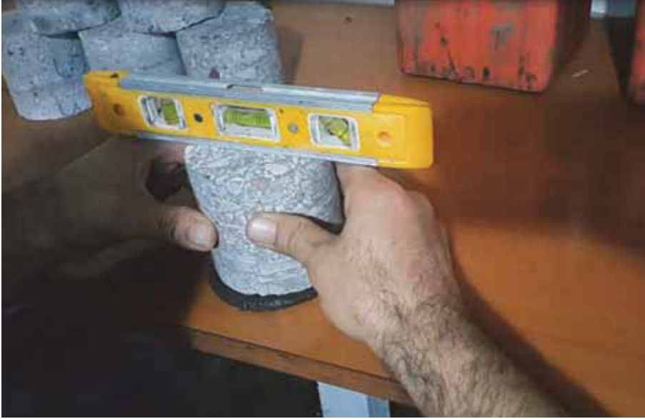
Şekil 23. Kalsiyum Alüminatlı Çimento ile Karot Başlıklama Yapılması
