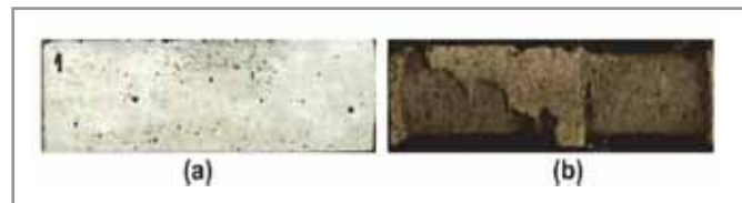
Şekil 3. Geleneksel beton numuneleri: (a) asidik ortamda bekletilmeden önce, (b) 60 gün asidik ortamda bekletildikten sonra [20]
