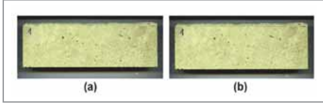
Şekil 4. Susuz beton numuneleri: (a) asidik ortamda bekletilmenden önce, (b) 180 gün asidik ortamda bekletildikten sonra [20]
