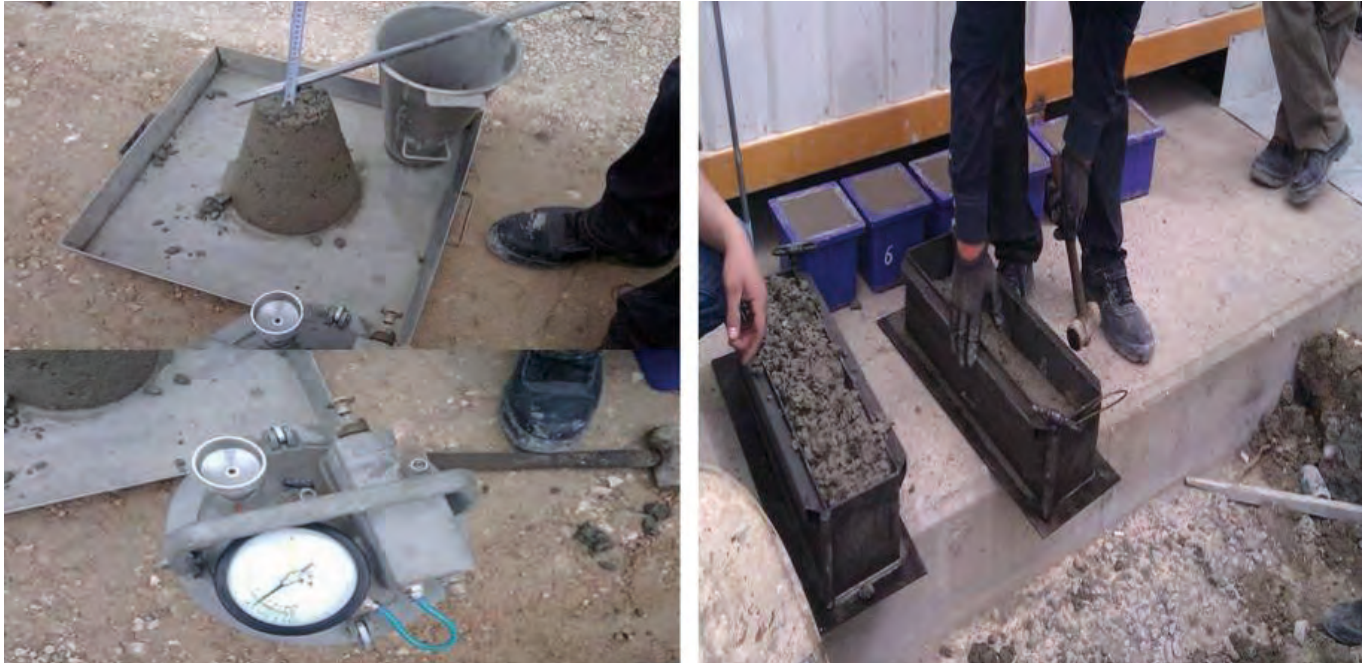
Resim 7: Beton slump deneyi ve numune alımı
