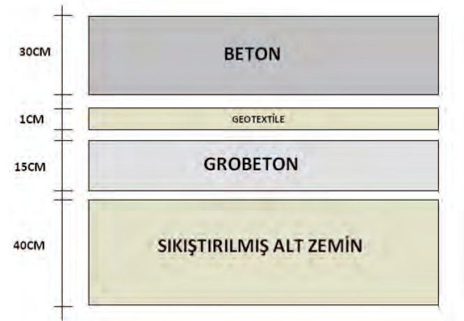
Şekil 2: Yol kaplaması kesiti
