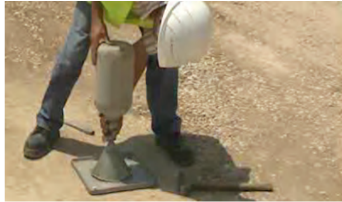
Resim 4: Kum konisi testi
