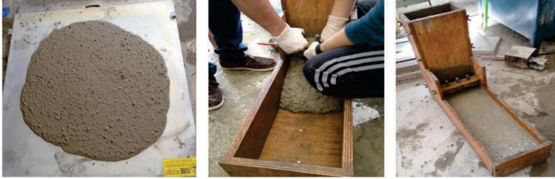
Şekil 2. Çökme-yayılma ve L kutusu deneyleri
