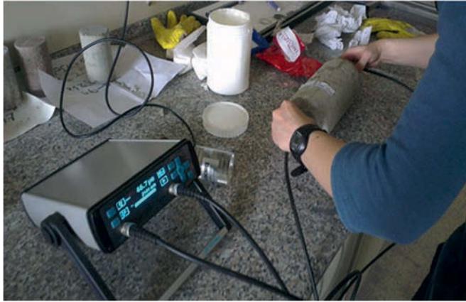
Şekil 3. Silindir örneklerde ultrases hızı ölçümü
