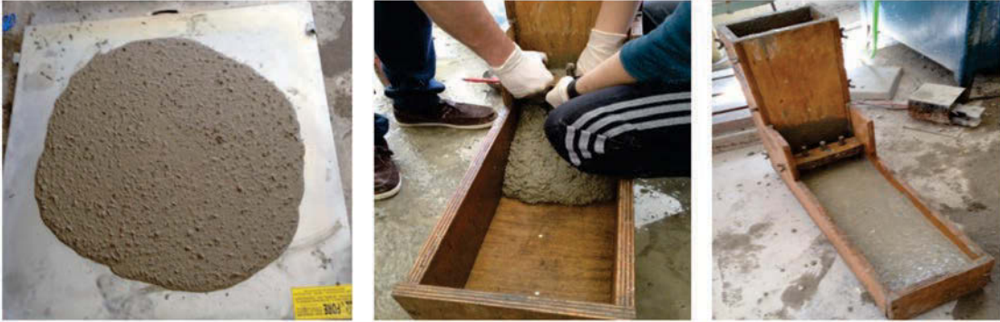
Şekil 2. Çökme-yayılma ve L kutusu deneyleri
