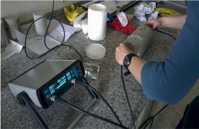
Şekil 3. Silindir örneklerde ultrases hızı ölçümü
