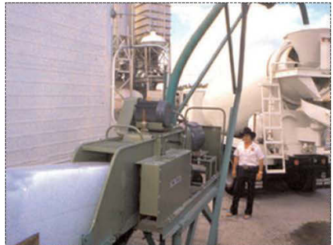
Resim 2: Beton karışım suyuna buz parçaları eklenmesi
