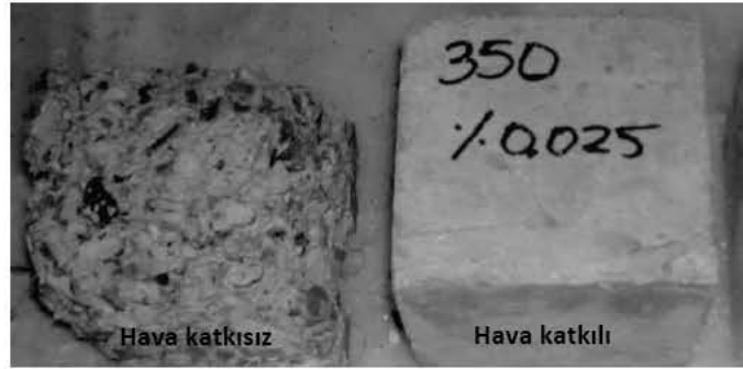
Şekil 4. 140 donma-çözölme devrine maruz kalmış beton örnekler
