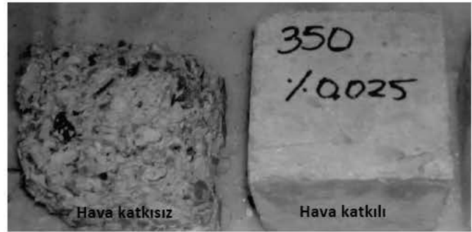
Şekil 4. 140 donma-çözölme devrine maruz kalmış beton örnekler
