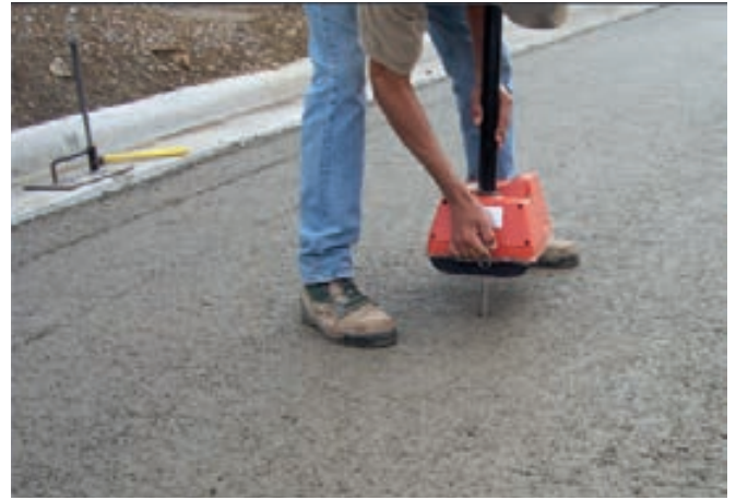
Şekil 8. Yoğunluk ölçümünde nükleer cihazların kullanımı [1]
