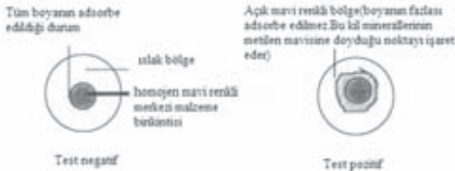
Şekil 1 - Metilen Mavisi Deneyinde Yapılan Leke Deneyi
