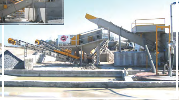
YAŞ BETON GERİ DÖNÜŞÜM TESİSİ
