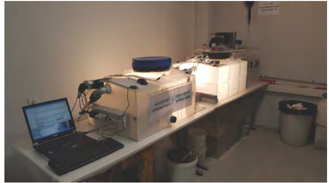
Şekil 5. EN 13295 Karbonatlaşma direnci deney düzeneği
