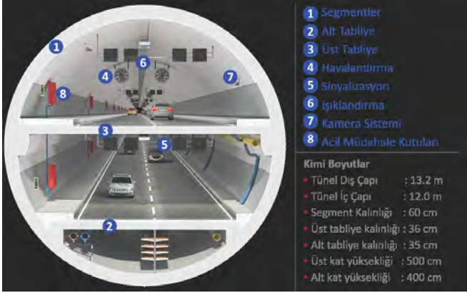
Şekil 1: Avrasya Tünelinin içten görünümü ve kimi geometrik boyutları
