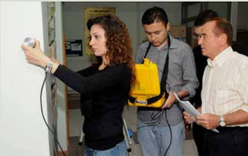
Şekil 3. - Bir Betonarme kolonda Ultrases V_p - boyuna dalga hızının ölçülmesi
