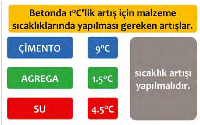
Şekil 6: Ham madde sıcaklık artışının beton sıcaklığına etkisi
