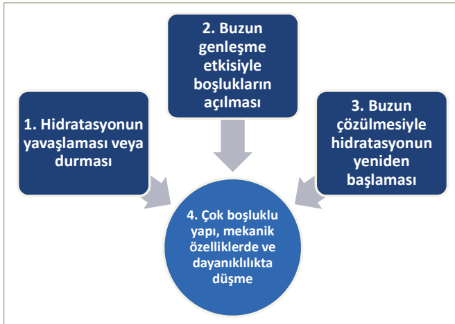
Şekil 3: Donma-çözülmenin taze betona etkisi
