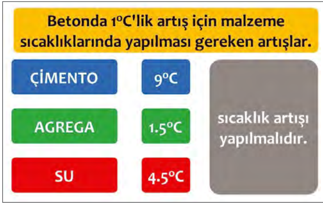
Şekil 6: Ham madde sıcaklık artışının beton sıcaklığına etkisi
