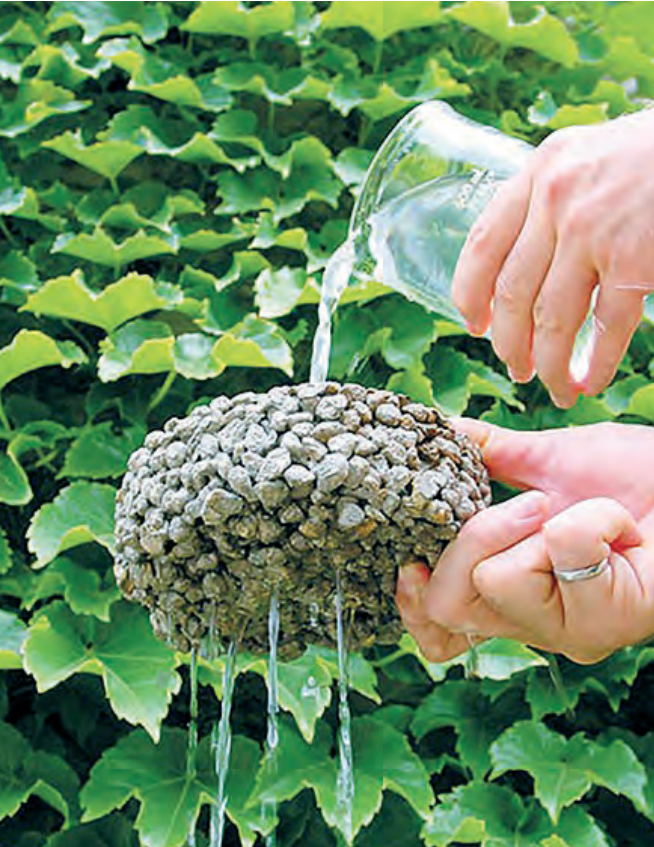
Şekil 4a: Geçirimli beton uygulamaları ve kesit örneği
