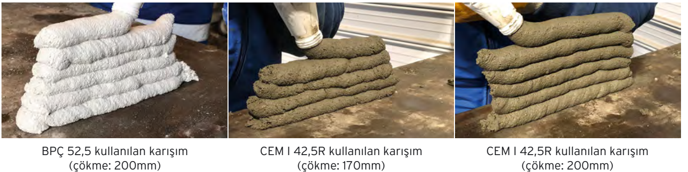
Şekil 4. Farklı çökme değerlerinde inşa edilebilirlik
