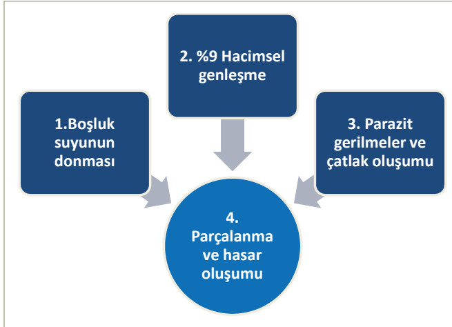
Şekil 4: Donma-çözülmenin sertleşmiş betona etkisi
