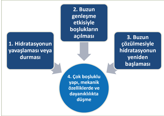
Şekil 3: Donma-çözülmenin taze betona etkisi
