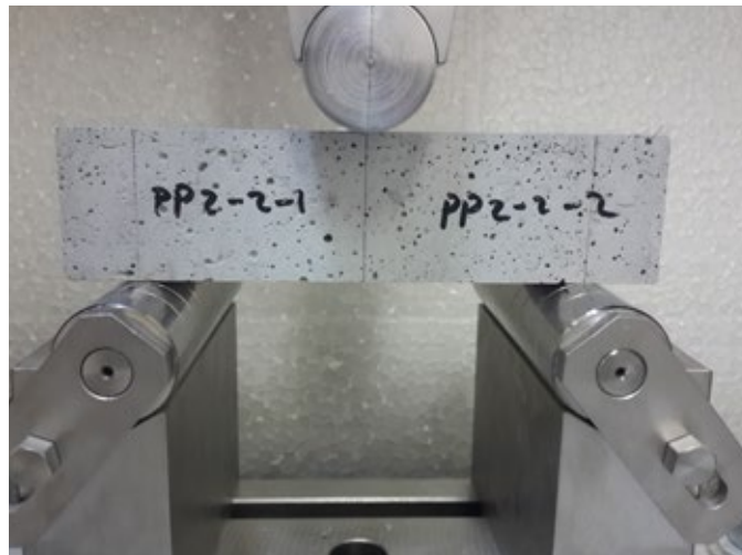
Şekil 4. a. Eğilme b. Basınç dayanım testleri
