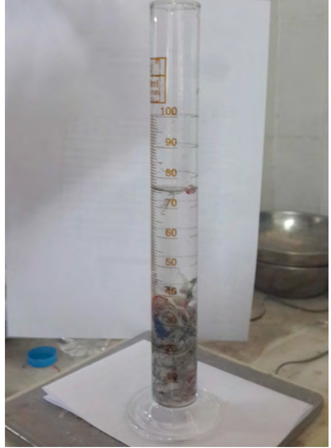
Şekil 2. Özgül ağırlık testi
