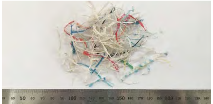
Şekil 1.a. Yıkama ve kesme işlemleri b. Karışımlara katılan polipropilen lifleri
