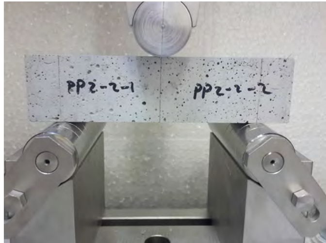
Şekil 4. a. Eğilme b. Basınç dayanım testleri
