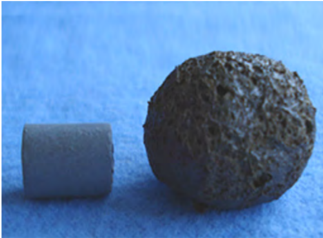
Şekil 1. Ham pelet ve genleştirilmiş agreganın görünümü.
