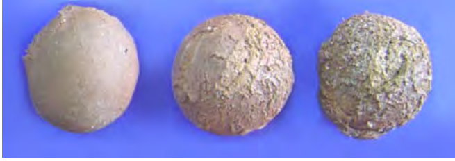
Şekil 8. Genleşmiş agregalar için farklı piroplastik sinter kabuk formları.
