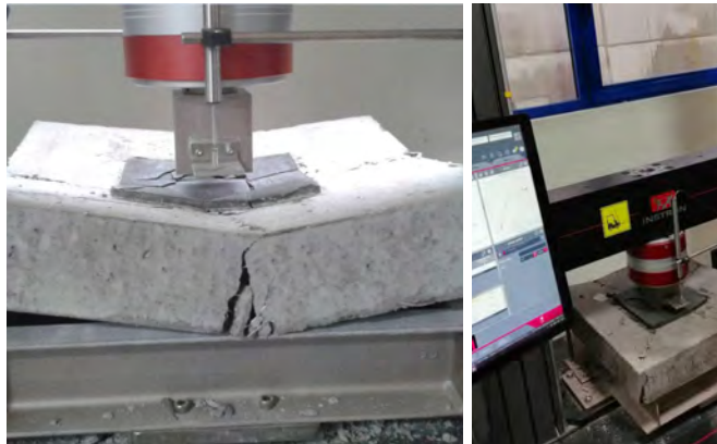
Şekil 3. EN 14488-5 Test Düzeneği
