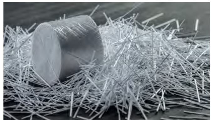
Şekil 1. Makro sentetik fiber donatı
