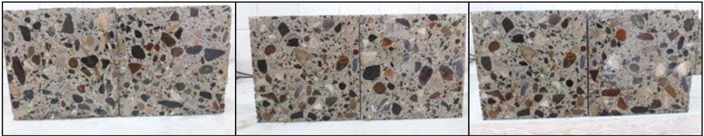
Şekil.6 C30/37 45 sn., 60 sn., 75 sn. karışım süresi çalışmaları en kesitleri
