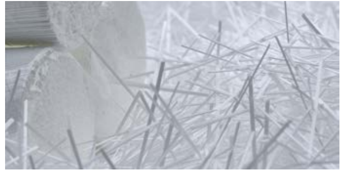
Şekil 1: Makro Sentetik Lif / Makro sentetik fiber donatı
