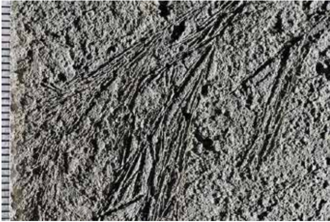
Şekil 1. Donmuş beton içinde bulunan buz kristalleri. Bu numune, donmadan kaynaklanan hasar sonucu mikro çatlak oluşumu yaklaşık olarak 5 cm derinliğe işlemiştir. Kaynak: David Rothstein, DRP, A Twining Company
