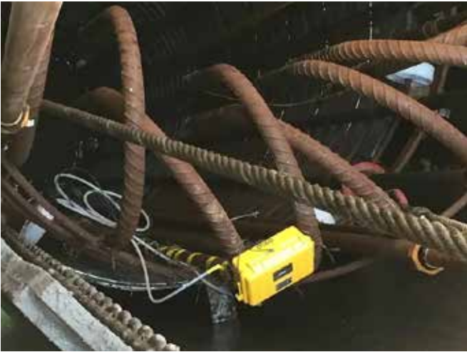
Şekil 3. Uzaktan, kablosuz ve anlık olarak beton sıcaklık ve dayanım (olgunluk) verilerini ileten, köprü ayağına tutturulmuş olgunluk derecesi sistemi. Kaynak: John Gnaedinger, Con-Cure
