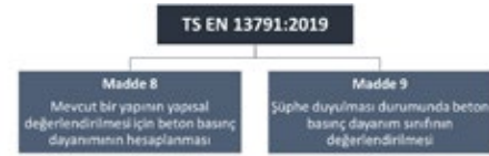
Şekil 1: TS EN 13791'e göre yerindeki dayanımın tayini
