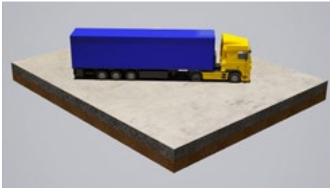
Şekil 3. Dingil 12 ton, Tek tekerlek 6 ton
