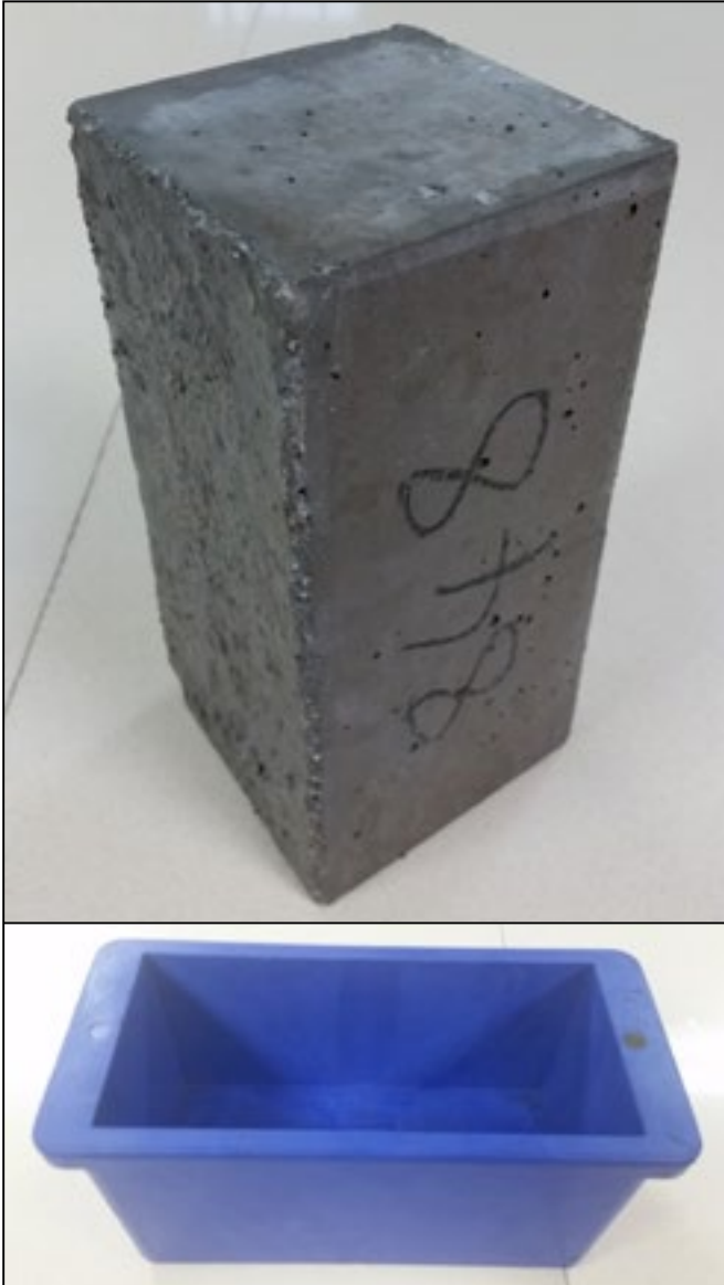
Şekil 1. Kare prizma şekilli numune ve kalıbı
