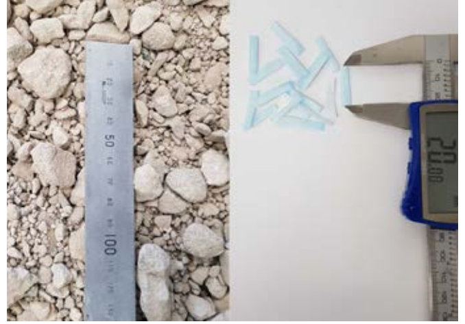
Yeni malzeme, geri dönüştürülmüş beton agregası ile (sol) parçalanmış yüz maskelerini harmanlıyor. (sağ).
