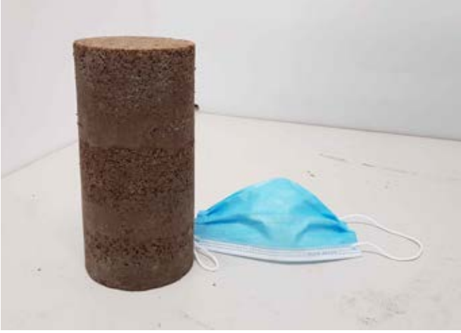
Yüz maskesi atıkları ve işlenmiş bina molozundan elde edilen geri dönüştürülmüş yol yapım malzemesi numunesi.
