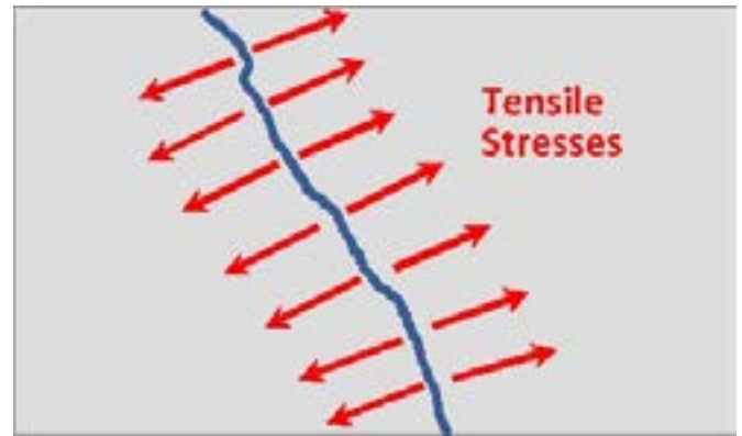
Figür 1. Kırmızı oklar, çatlağı oluşturan çekme gerilmelerini temsil eder. Çekme gerilmelerine neyin neden olduğunu belirlemek, çatlaklara plastik-büzülme, termal veya kuruma-büzülmesi çatlağı gibi bir açıklama getirmenin anahtarıdır.
