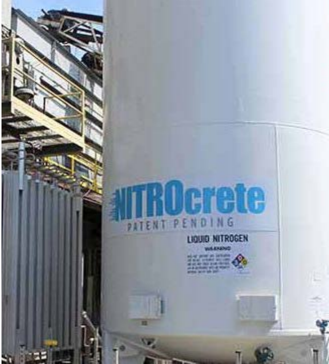
NITROcrete, betonun harmanlanması sırasında likit azot kullanılarak agregaları hızla soğutuyor
