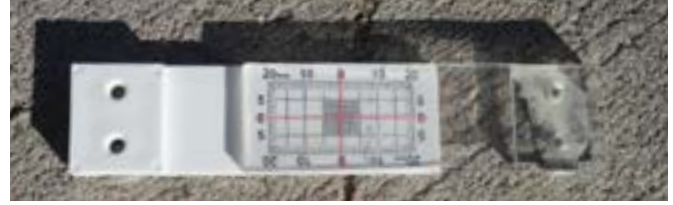
Fotoğraf 2. Vida veya epoksi kullanarak iki parçalı, kalibre edilmiş çatlak monitörünü çatlak üzerindeki betona monte edin. Şeffaf parçadaki kırmızı artı işareti, beyaz parçadaki ızgaraya göre hareket eder ve hareketin yönünü ve miktarını grafiksel olarak gösterir.
