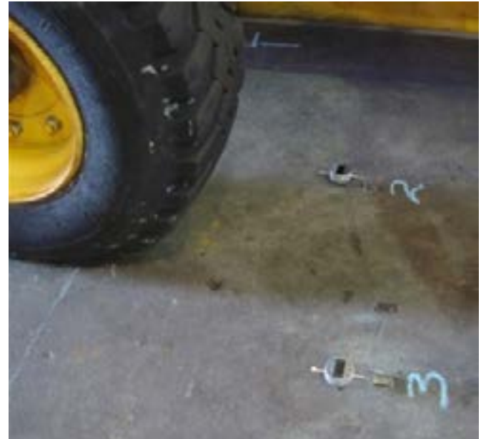
Fotoğraf 3. Ağır tekerlek yükü nedeniyle çatlak genişliğinin açılıp kapanmasını ölçmek için dijital cihazlar kullanılabilir.
