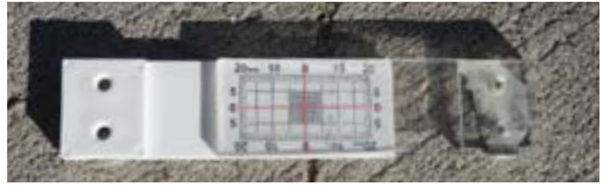
Fotoğraf 2. Vida veya epoksi kullanarak iki parçalı, kalibre edilmiş çatlak monitörünü çatlakın üzerindeki betona monte edin. Şeffaf parçadaki kırmızı artı işareti, beyaz parçadaki ızgaraya göre hareket eder ve hareketin yönünü ve miktarını grafiksel olarak gösterir.
