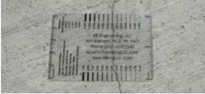
Fotoğraf 1. Bir çatlak karşılaştırma kartı kullanarak çatlak genişlikleri ölçülebilir.
