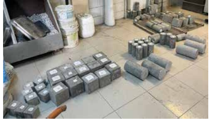
Foto 9: Test için hazırlanan küp-silindir numuneler
