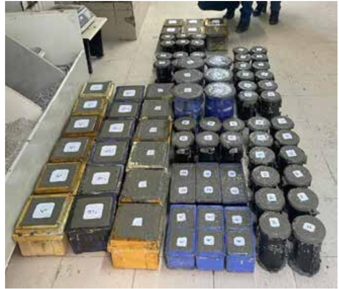
Foto 2: Kalıbındaki numuneler (iç ortam, SK)
