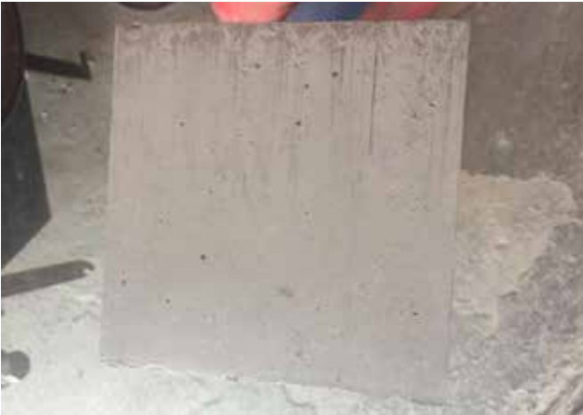
Foto 8: Küp yüzeylerindeki çizikler
