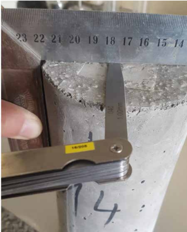
Foto 5: Deney 14, 1,00 mm geçiyor UYGUN OLMAYAN numune
