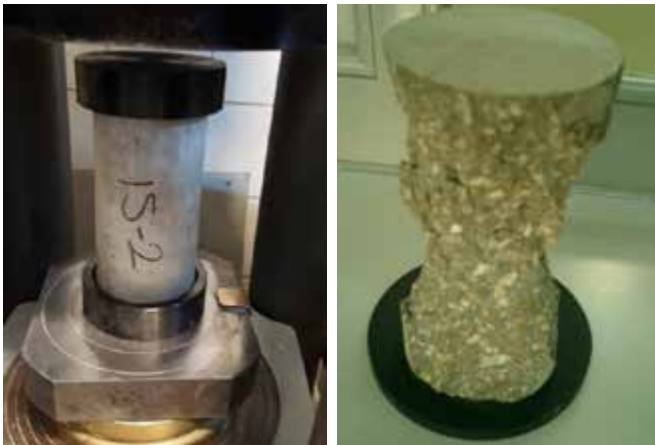
Foto 12: Deney 15, Kauçuk Başlık ile Numune TESTİ
