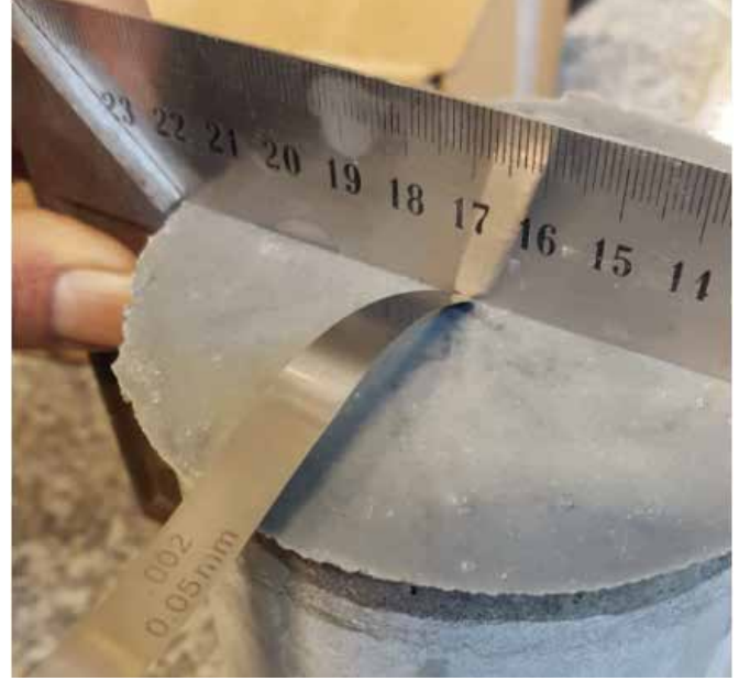
Foto 6: Deney 17, 0,05 mm geçmiyor 10/20 cm silindir, 0,06'da geçmez UYGUN numune
