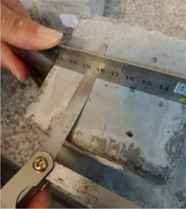
Foto 4: Deney 3, 0,06 mm geçiyor UYGUN OLMAYAN numune
