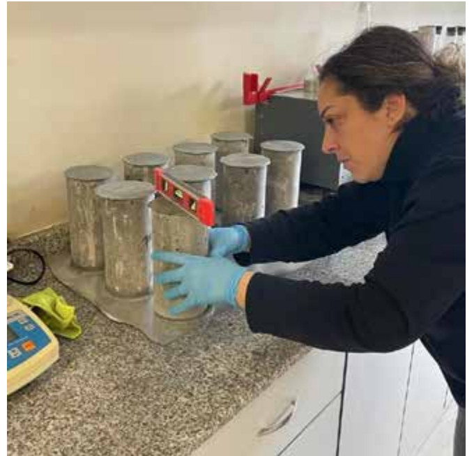
Foto 10 : 10/20 cm silindir EPOKSİ BAŞLIK yapımı
