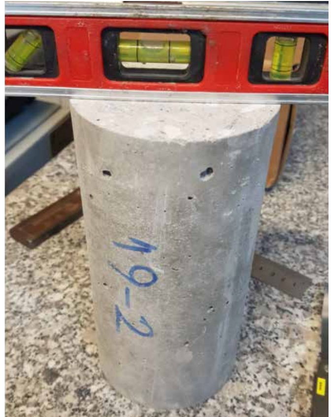
Foto 7: Deney 19, Su terazisi ile Alt-Üst yüzlerin paralelliği UYGUN numune
