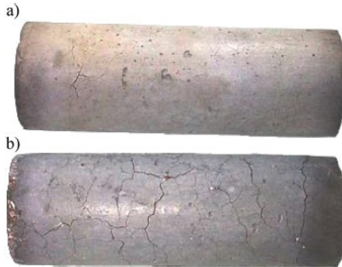
Şekil 2. 600°C'ye ısıtıldıktan sonra numunelerin yüzeyinde görünür çatlaklar a) Kalkerli agrega içeren beton b) Silisli-kalkerli agrega içeren beton [4]
