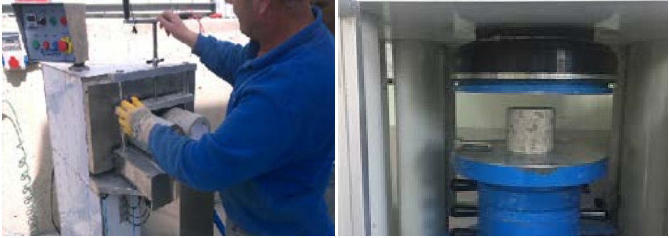
Şekil 4: Karot Numunesi Aşındırma, Başlıklama ve Kırım İşlemi
