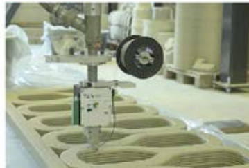
Şekil 3. Entegre tel takviyesi, modern sürüklenmiş tel baskı sistemiyle hemen hemen aynı şekilde yerleştirildi.
