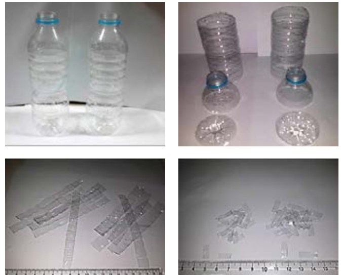
Şekil 2. PET şişe kesme ve lif oluşturma işlemleri
