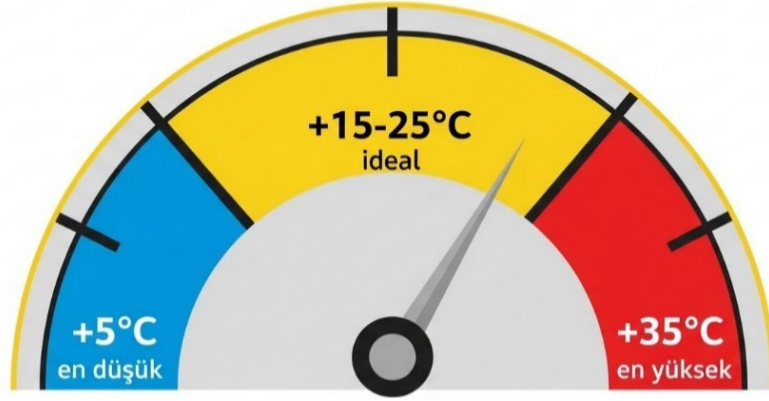
Şekil 5. En düşük, ideal ve en yüksek taze beton sıcaklıkları
