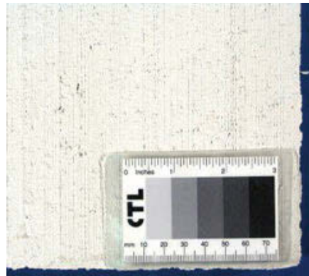
Güneş yansıtma oranlarını gösteren beton düzeyici test örnekleri
