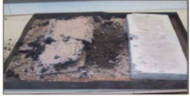
Şekil 1: 750 °C sıcaklıkta asfalt (solda) ve beton (sağda) performansının karşılaştırılması [3]
