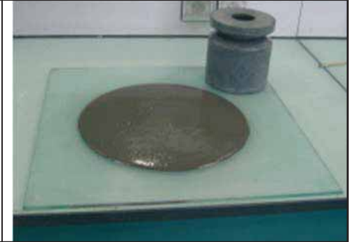
Figür 11: Mini Slump
