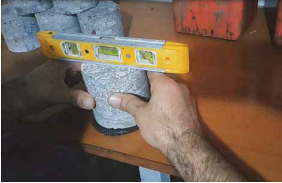
Şekil 23. Kalsiyum Alüminatlı Çimento ile Karot Başlıklama Yapılması
