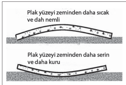
Şekil 4. Sıcaklık ve Nem Etkisinde Kıvrılma (Curling)
