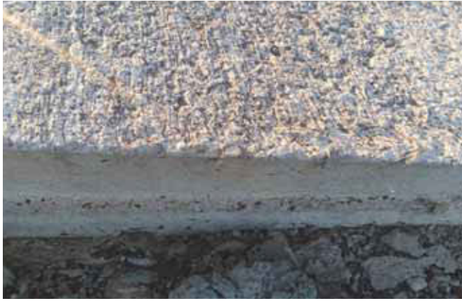
Şekil 21. Polipropilen Lif Donatılı Beton Yüzey Dokusu
