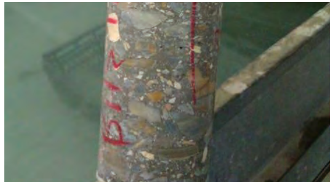
Resim 16: Karot numunesi alımı
