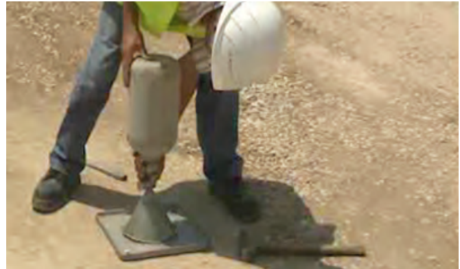
Resim 4: Kum konisi testi
