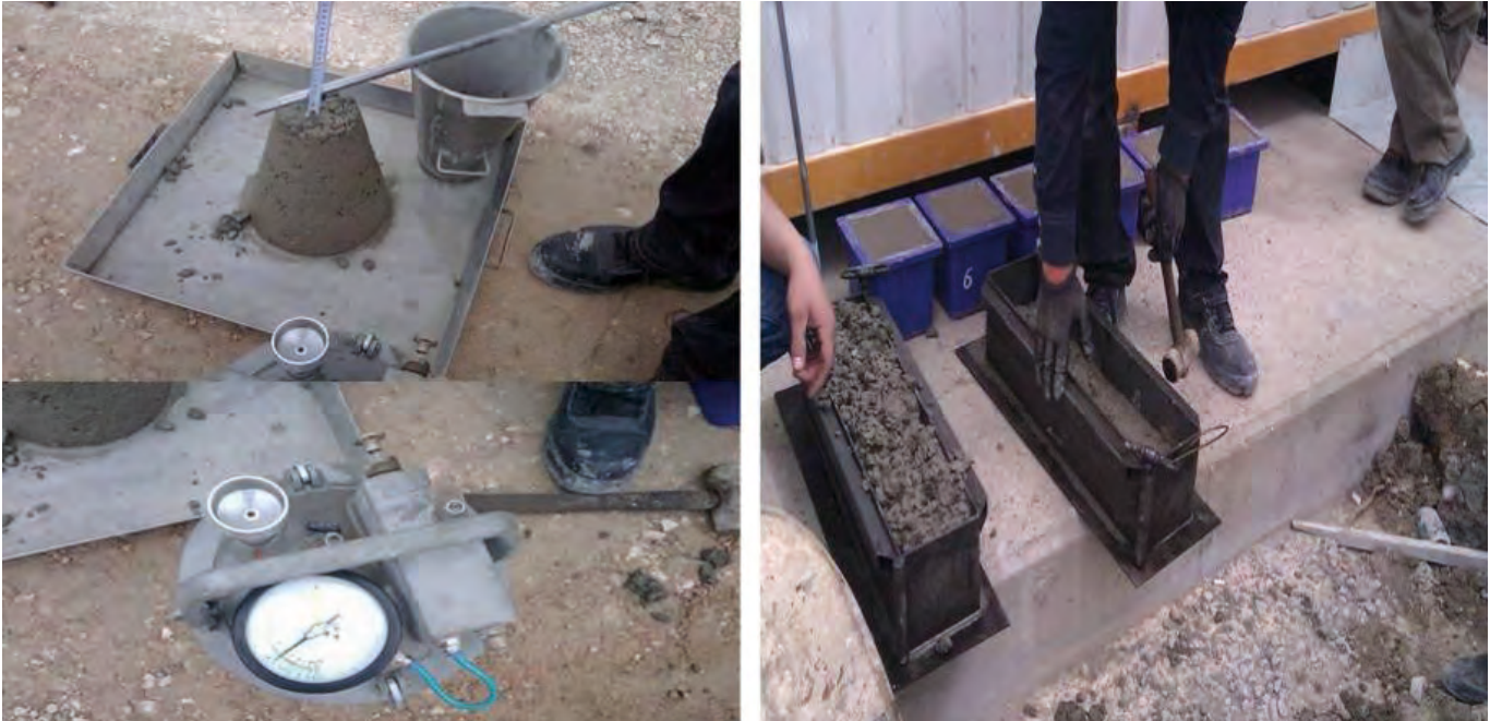
Resim 7: Beton slump deneyi ve numune alımı
