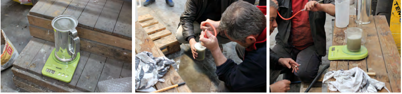
Şekil 1: Tartım Yöntemiyle Yoğunluk Ölçümü
