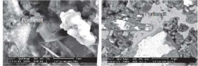
Şekil 7: (Soldaki resim) Hekzagonal portland kristal yığını - SE modu. (Sağdaki resim) Çimento hamuru içerisinde portlandit dağılımı - BSE modu.
