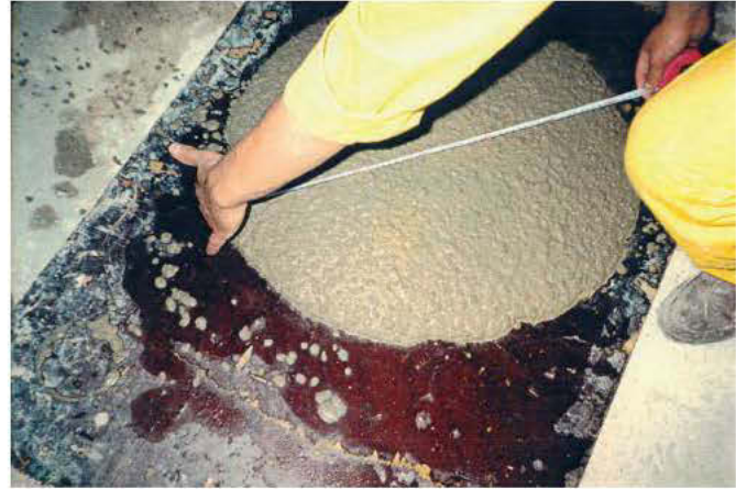
Şekil 4. KYB'da çökme-yayılma deneyi.
