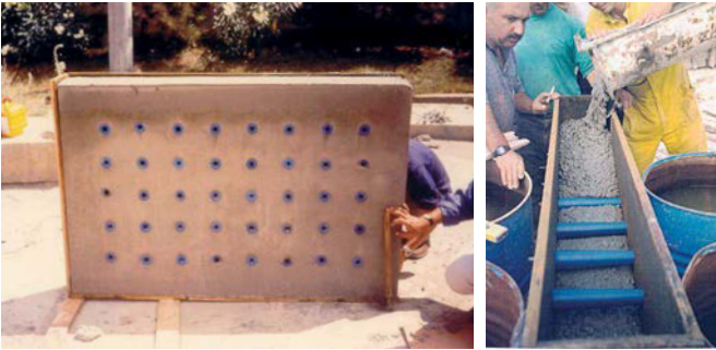
Şekil 9. Ayrışma ve doldurma yeteneği ölçme (Kalıp sadece bir noktadan doldurulmaktadır) [8,18].
