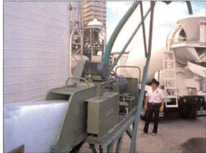
Resim 2: Beton karışım suyuna buz parçaları eklenmesi
