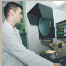
Deney Eleği Kalibrasyonu
