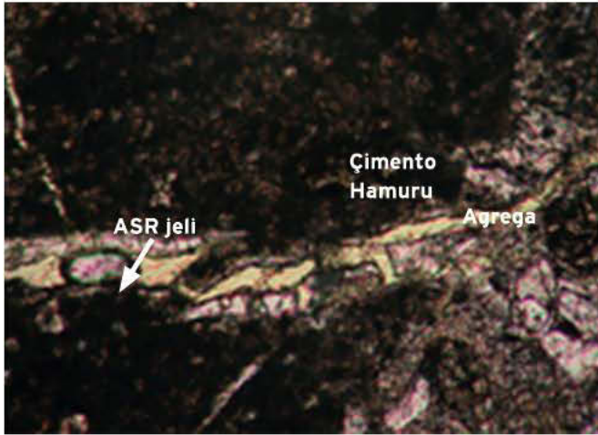
Şekil 3. Agregadan çimento hamuruna sızan ASR ürünü, ince kesit analizi (alan 0.5x0.7mm 2 ) [40]
