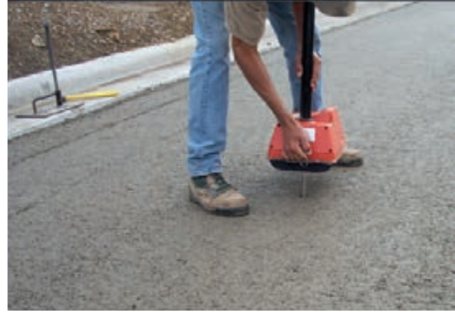
Şekil 8. Yoğunluk ölçümünde nükleer cihazların kullanımı [1]
