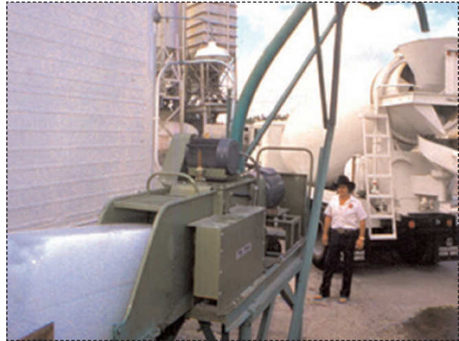
Resim 2: Beton karışım suyuna buz parçaları eklenmesi
