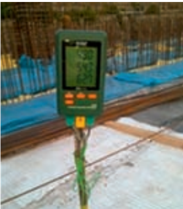
Şekil 3.2. (a) Termocouple kablolarının 3 girişli data logger montajı, (b) betonun yorganlar ile korunması
