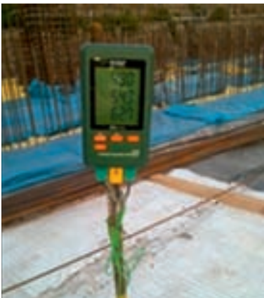
Şekil 3.2. (a) Termocouple kablolarının 3 girişli data logger montajı, (b) betonun yorganlar ile korunması
